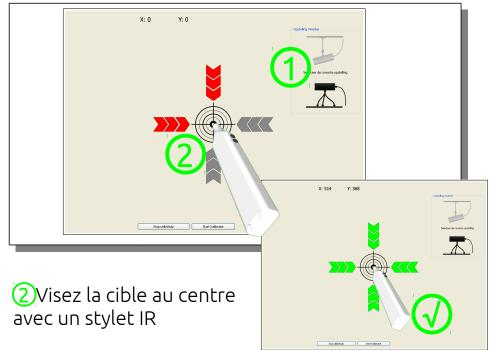
Déplacez le capteur en fonction des flèches jusqu'à ce qu'elles soient vertes.
