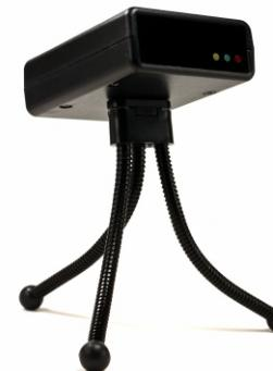
Richt de Vmarker IR-sensor USB met de voorkant (de kant van de LED's) naar het projectievlak.
